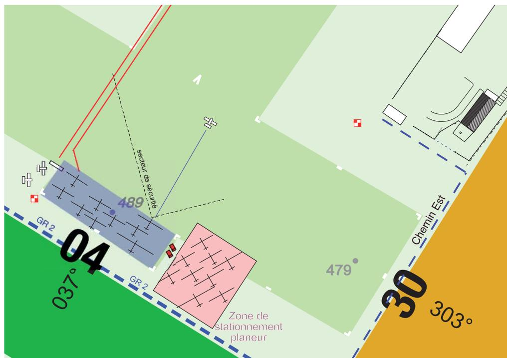
FIGURE 9 – Configuration 04 avec atterrissages 04, vent fort, remorquage et treuil.
